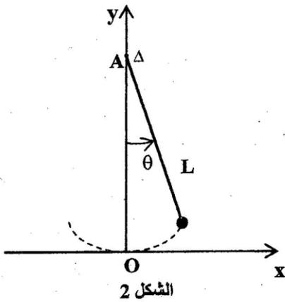
تزيح النواس عن موضع توازنه المستقر بزاوية  $\theta_m$  ثم نحرره بدون سرعة ببنية عند اللحظة  $t=0$ ، فينجز تذبذبات حرة في المستوى  $(O,x,y)$  حول محور ثابت  $\Delta$  أفقي يمر من النقطة  $A$ .
