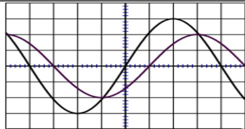
En faisant varier la fréquence du G.B.F, on peut remarquer, en utilisant les oscillogrammes, que les deux tensions  $u(t)$  et  $u_R(t)$  ont la même période (même fréquence) on dit que les oscillations de la tension  $u_R(t)$  sont imposées par le générateur, l'oscillateur n'est pas libre et les oscillations sont dites forcées
